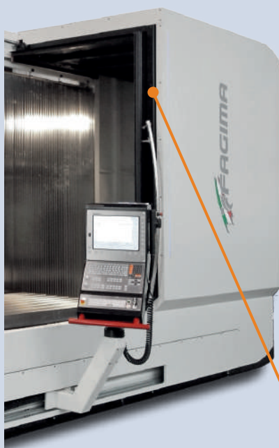
Porte telescopiche interne anche automatizzate, a totale scomparsa con convogliamento dei liquidi prevenendone perdite sul pavimento.
