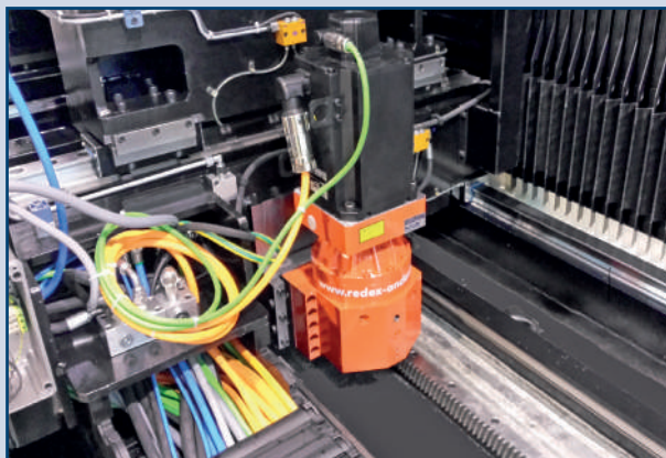
Doppio motore e cremagliera sull'asse X. Double motor and rack on X axis.
