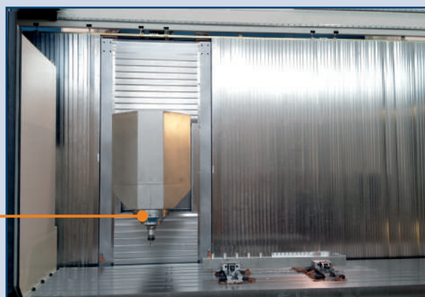
Testa speciale con elettromandrino HSK63 da 18000 giri.
