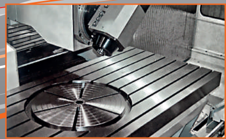
Testa e tavola girevole per tornitura / fresatura. Head and rotary table for turning / milling.
