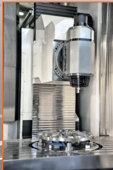
Testa tiltante (+-120°) e tavola girevole annegata. Tilting head (+-120°) and embedded rotary table.
