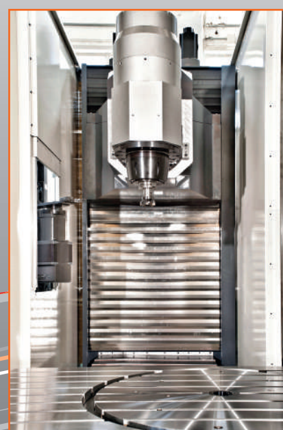
Opz. Heavy duty kit caratterizzato da un potente elettromandrino (400 Nm) qui durante operazione cambio utensile. Opt. Heavy duty kit having a powerful electrospindle (400 Nm) here shown during tool change operation.
