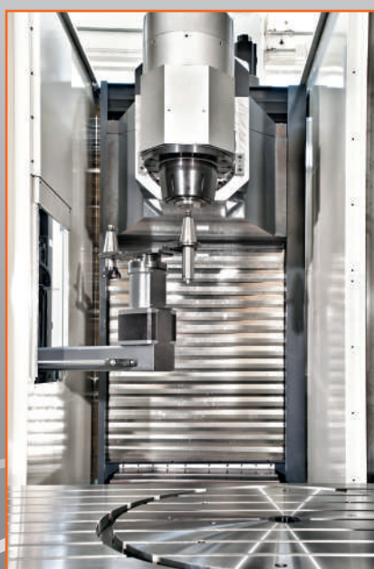
Opz. Heavy duty kit caratterizzato da un potente elettromandrino (400 Nm) qui durante operazione cambio utensile. Opt. Heavy duty kit having a powerful electrospindle (400 Nm) here shown during tool change operation.
