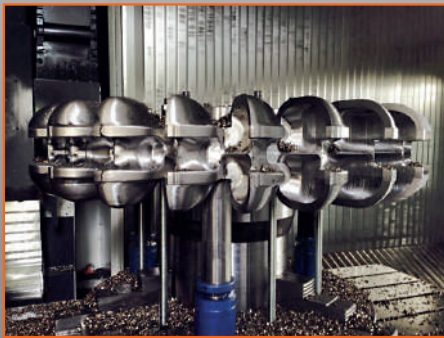
Turbina interamente lavorata con una Dominus con kit fresatura / tornitura. Turbine entirely made by a Dominus equipped with turning / milling kit.
