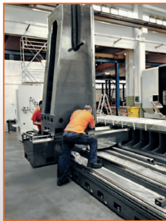
L'imponente colonna con sistema a ponte di doppia vite a sfera, elemento che contraddistingue il modello Dominus Big. The massive column with a double ball screw gantry system, peculiarity of Dominus Big range.
